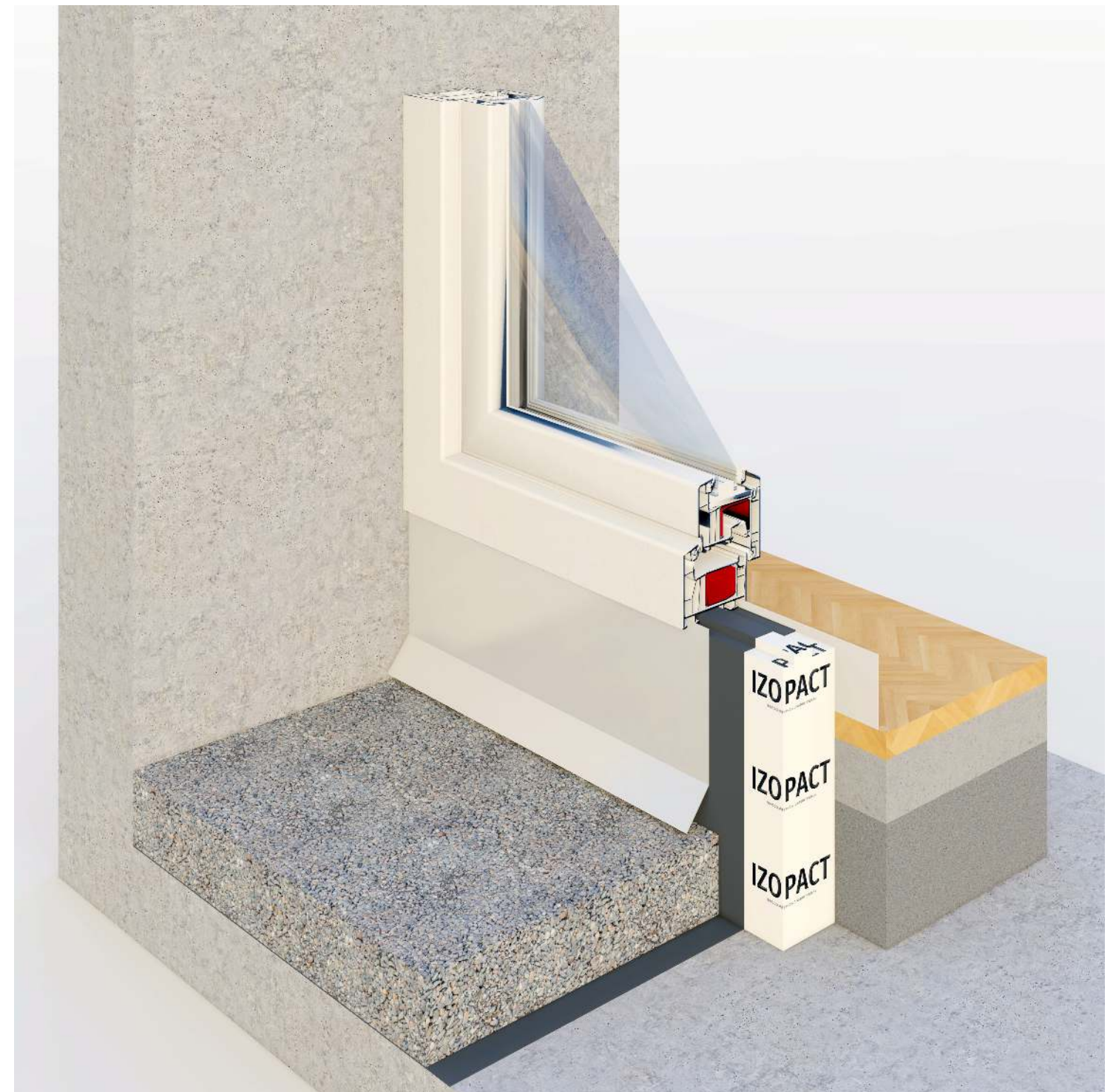
Profil termoizolant pentru prag de usi
